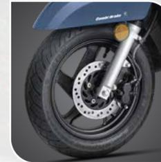
**TELESCOPIC SUSPENSION AND FRONT DISC BRAKE**
